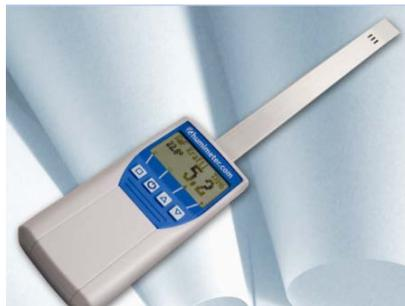
Bild: Papierfeuchtemessgerät, Schaller GmbH
